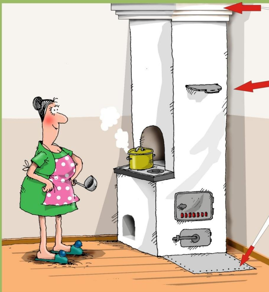
**разделка** - утолщение в кладке печи и дымохода, создающее малотеплопроводимый слой между нагретой частью печи и легковоспламеняющимися элементами
